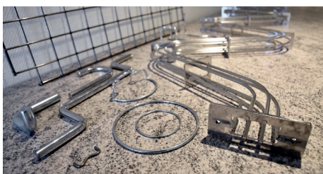
↑ En enkel bockad tråddetalj, trådringar och svetsade trådnät – ofta är det i enkelheten man hittar de stora vinsterna.
